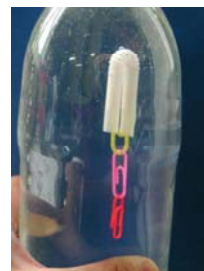
ペットボトルを押すことによって沈む浮沈子
